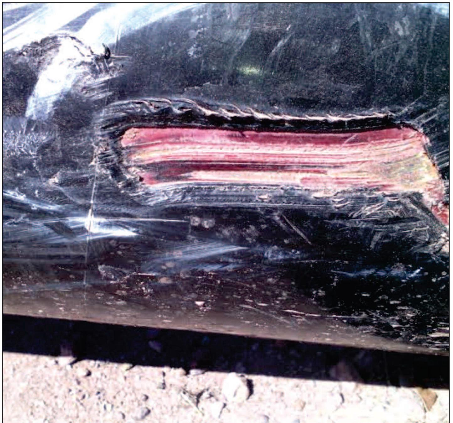
**La inexperiencia de los obreros aunado con la falta de equipo adecuado para manipular la tubería provocó graves daños en la misma, sin embargo en vez de reemplazarla o por lo menos repararla, se hicieron los occisos y la enterraron, sembrando una bomba de tiempo.**
